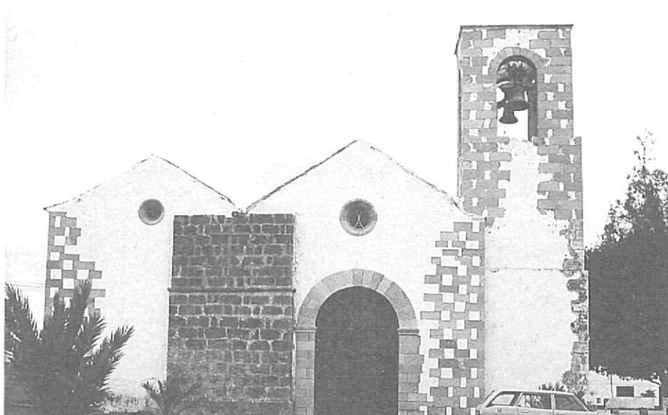
**Figura n.º 5.** La limpieza indiscriminada de sillares y elementos de cantería puede alterar la imagen tradicional de los edificios. Iglesia de San Miguel Arcángel, Tuineje (Fuerteventura).
